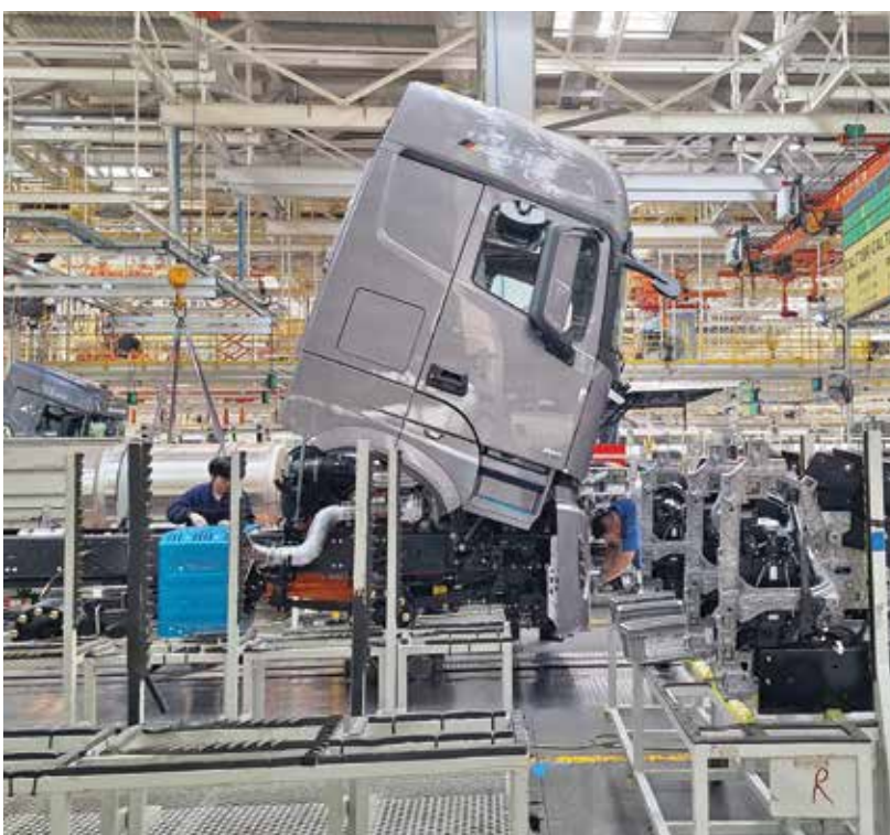
Proceso final de control antes de encender el camión. Cabina hecha por robots.
