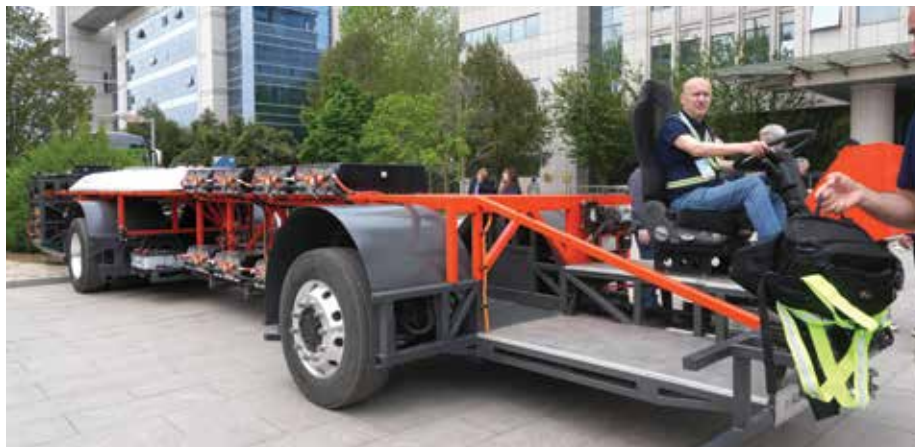
Chasis eléctrico para bus interprovincial.
