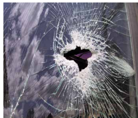
Vidrio no certificado: al romperse, genera fragmentos peligrosos tipo cuchillas.
