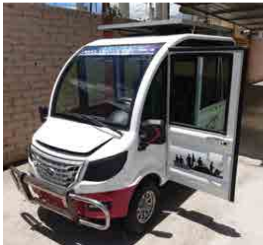
El “J.V.E.” de la empresa Mekatronix tiene el panel solar en la parte superior.
